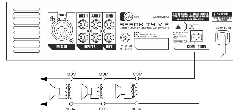
Все усилители серии ReBox работают только совместно с трансляционными 100V акустическими системами. То есть акустические системы должны иметь понижающие трансформаторы. Все акустические системы должны быть подключены параллельно. Суммарная мощность всех акустических систем подключенных к усилителю не должны превышать заявленную мощность усилителя:
