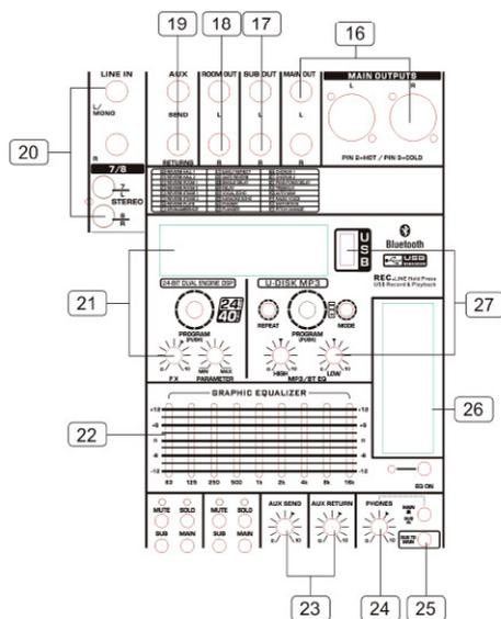
16. Main out. Вы можете использовать эти выходы, например, для подключения к усилителю мощности, управляющего основными громкоговорителями. Также имеет выходы на разъем XLR и Jack.
