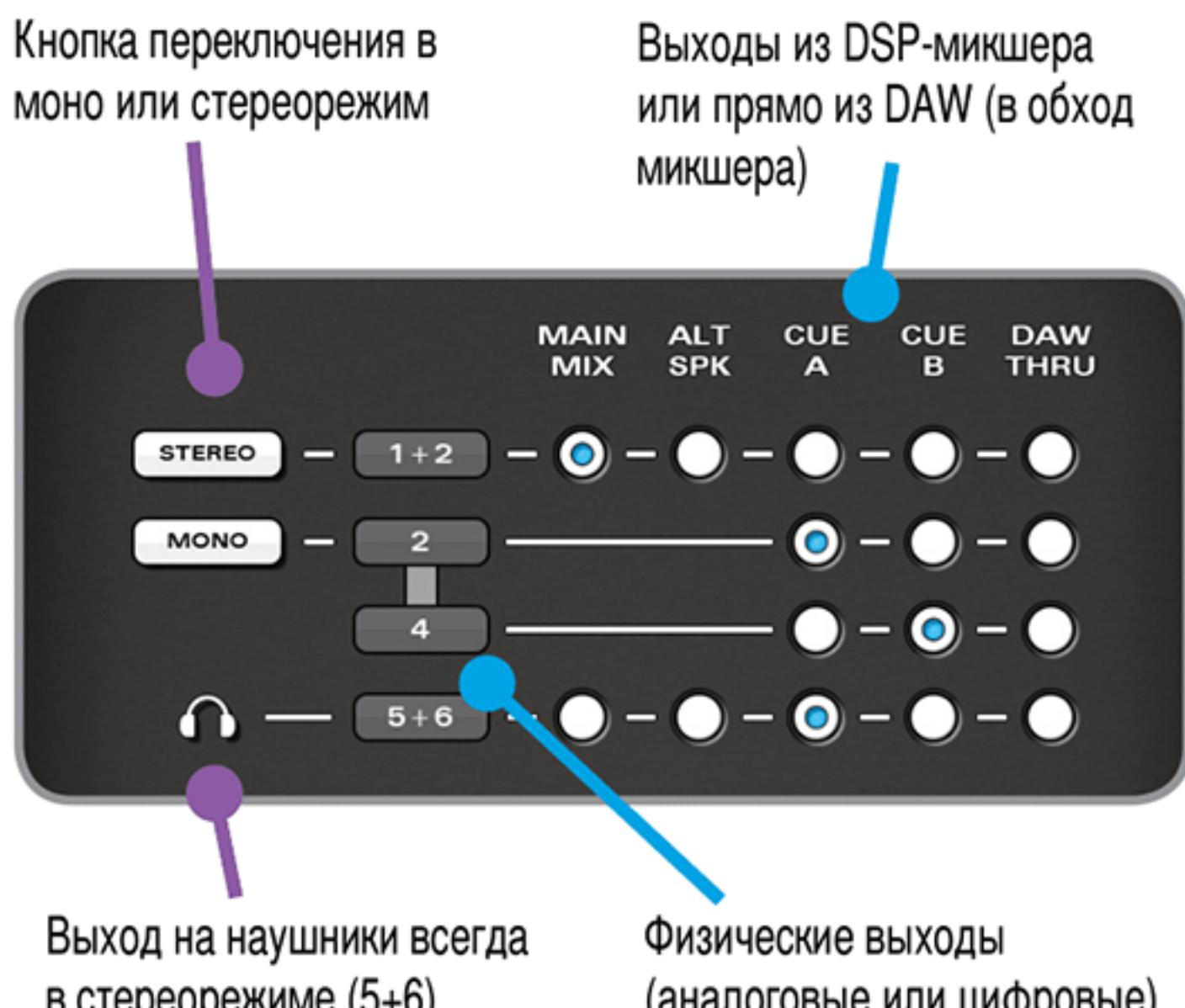
В вышеприведенном примере выходы из ЦАП 1+2 заданы, как стереопара, сигнал на которую приходит из основного выхода DSP-микшера. По умолчанию эта схема используется для подключения основных контрольных мониторов. Сигнал с основного выхода iD-микшера проходит через секцию управления мониторами со всеми её функциями (моносумма, разворот полярности, ослабление, отключение и громкость).
