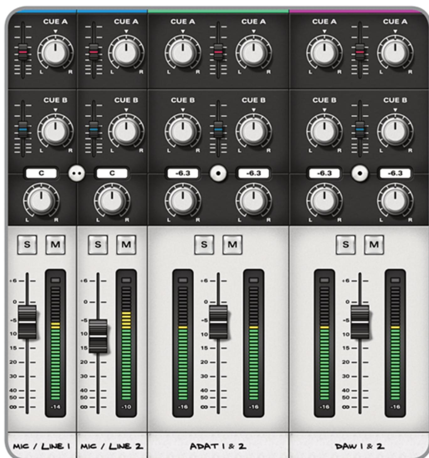
**Аналоговые** входные каналы поступают в микшер прямо с двух АЦП (возвратов точки разрыва). Здесь могут быть следующие сигналы: микрофонный, линейный, сигнал с ди-бокса (канал 2) или линейный сигнал с гнезд возврата в точке разрыва.
