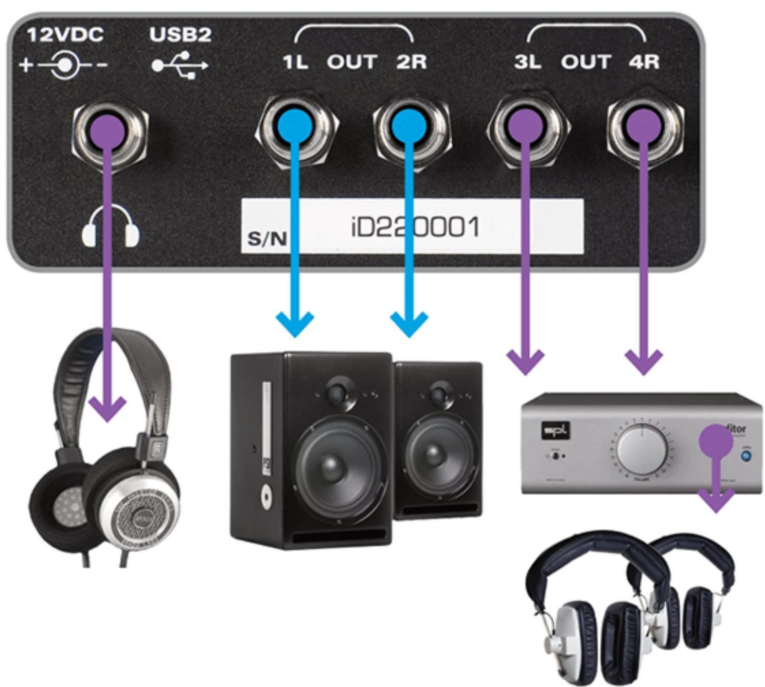
Использование iD22 при сведении с использованием дополнительных мониторов:
