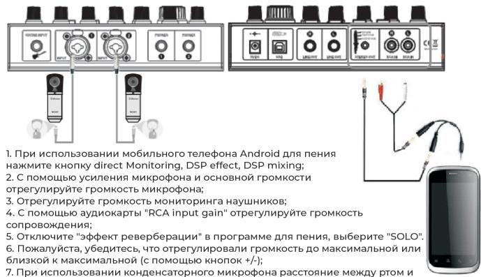
1. При использовании мобильного телефона Android для пения нажмите кнопку "Mixing", "DSP effect", "DSP mixing";
